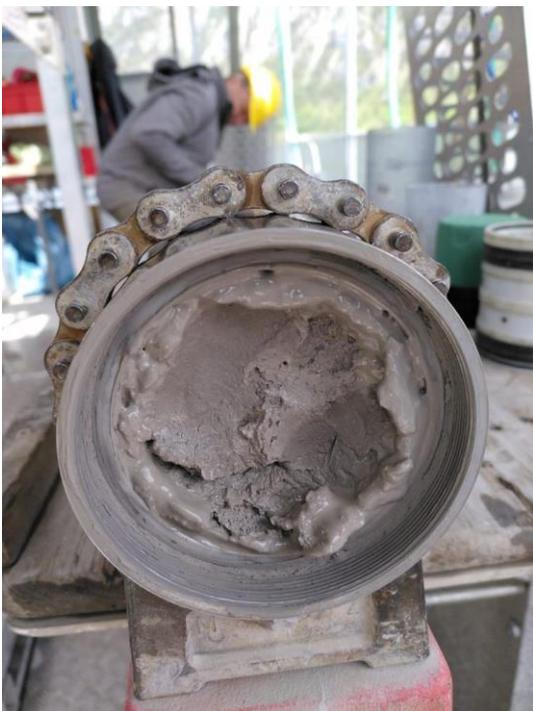
Core-Catcher mit dem tiefsten beprobten Sediment;
